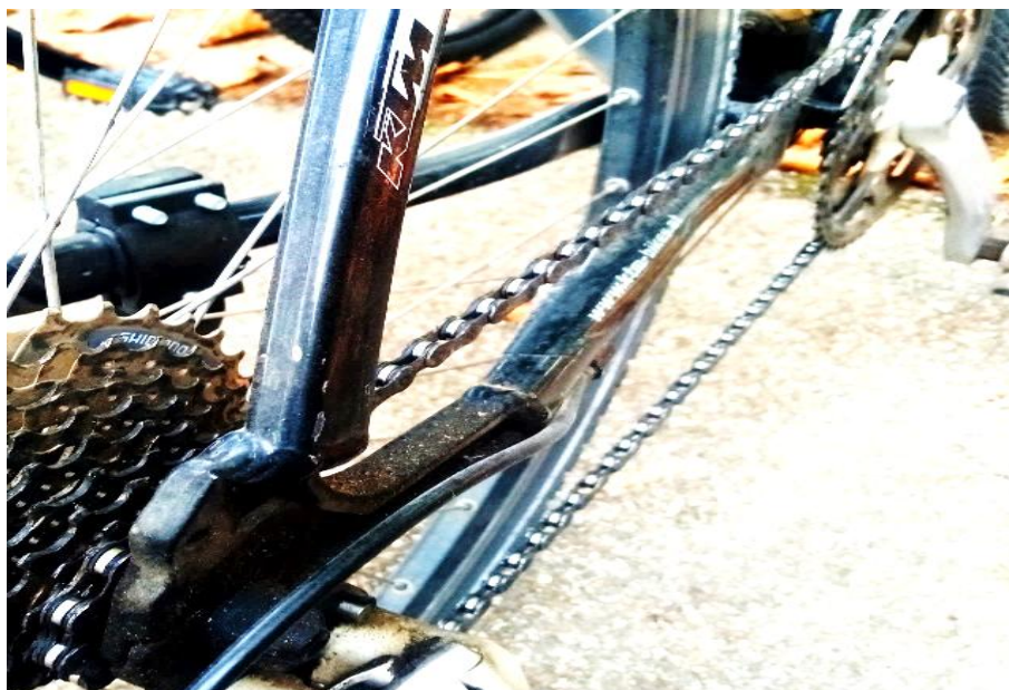
6. ábra. A legkisebb fogaskerék - középső lánckerék használata gyakori hiba, (saját felvétel)
