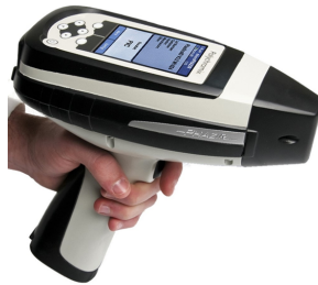
2. ábra. Kézi eszköz (MicroPHAZIR PC Handheld NIR Spectrometer, [6])
