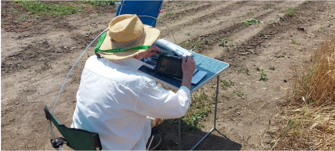
2. ábra. Frissen gyűjtött levélminták terepi felvételezése a levélspektrométerrel.
