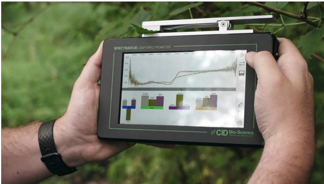
3. ábra. Tipikus reflexiós spektrum a CI-710s levélspektrométeren.
