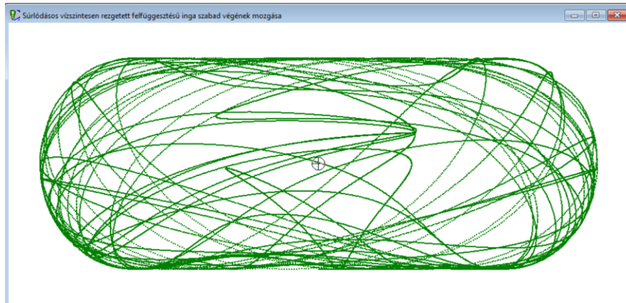
5. ábra: a súrlódásos vízszintesen periodikusan rángatott inga végpontjának kaotikus pályája
