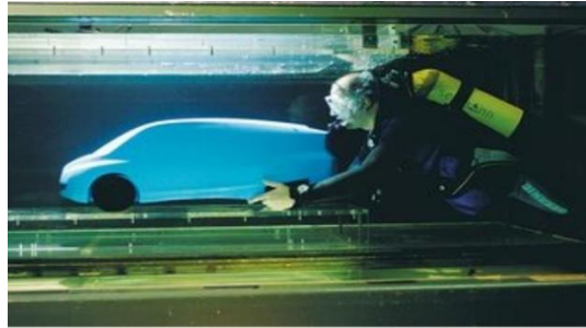
13.. ábra: gépkocsi modell tesztelése vízcsatornában
