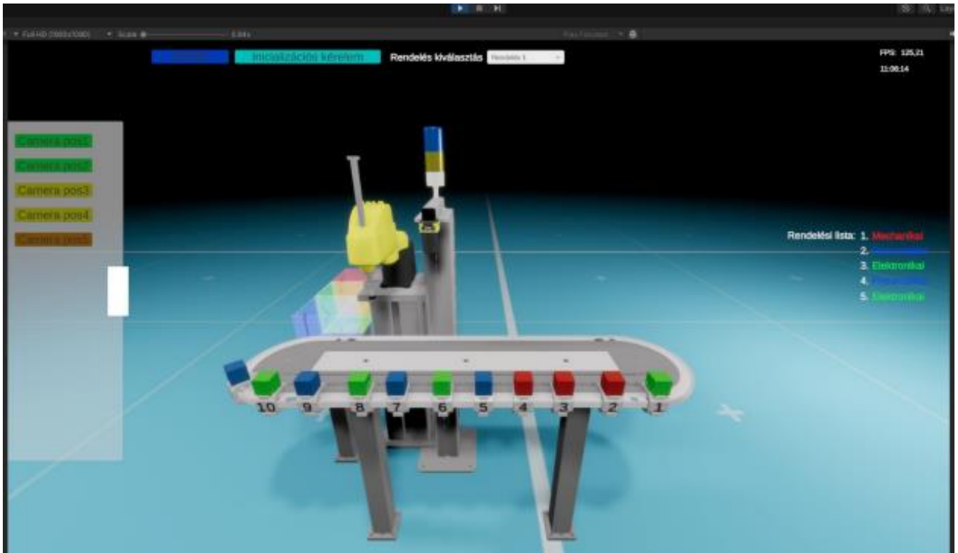
3. Ábra Unity-vel készült PLC verseny feladat rekonstrukciója
