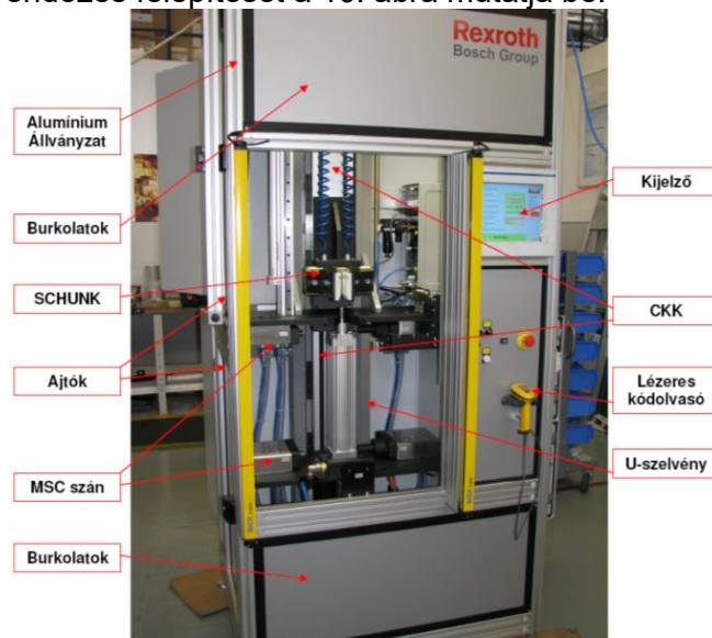
10. ábra VDMA vizsgáló berendezés szerkezeti kialakítása
