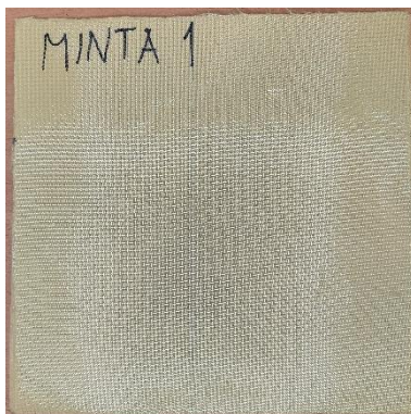
1. ábra – Pillanatragsztó kötésű próbadarab
