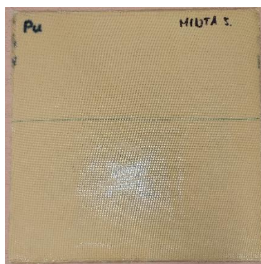
3. ábra – Poliuretán öntőgumi kötött próbadarab
