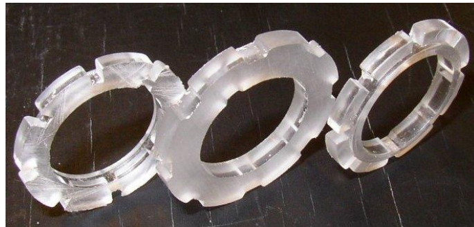
9. ábra. Szeletelt PC alaptest, feszültségoptikai vizsgálatra kész állapotban
