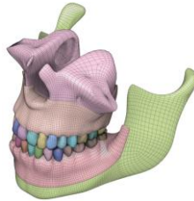
2. ábra. Eredeti állkapocs modell hexaédes felépítése
