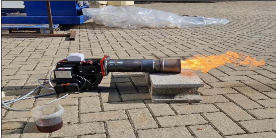
1. ábra: A nyitott égésterű vizsgálat szabadtéren
