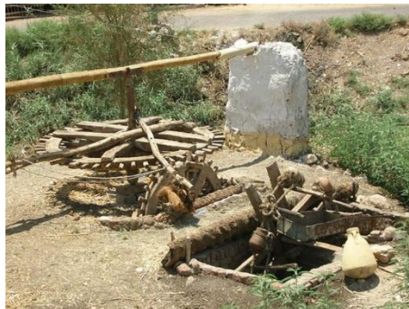
3. ábra. Fából készült fogaskerék mechanizmus [11]
