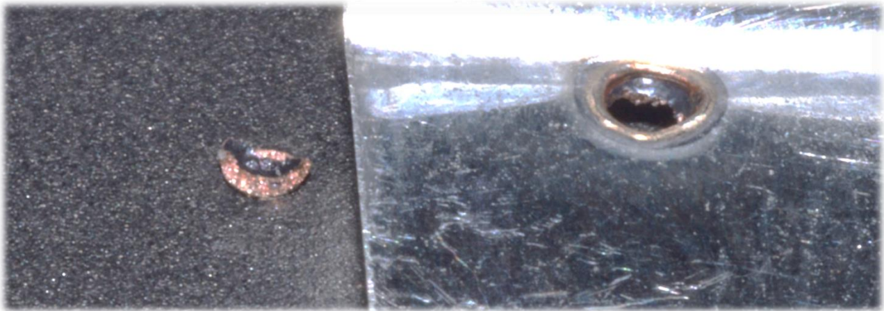
11. ábra: Lézersugaras hegesztés szakítást követően
