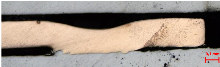
5. ábra: Ellenállás dudorhegesztett kötés(negatív kupak, bal oldal)
