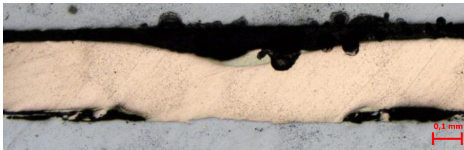
6. ábra: Ellenállás dudorhegesztett kötés(negatív kupak, jobb oldal)
