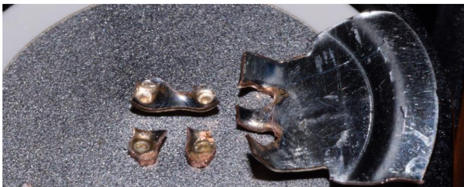
7. ábra: Ellenállás dudorhegesztett kötés kigombolódott
