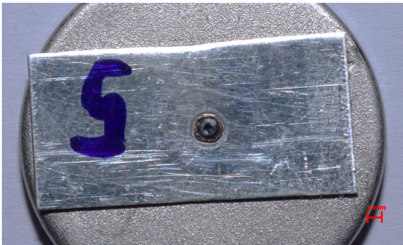
8. ábra: Lézersugaras hegesztés homlokl felülete (negatív oldal)
