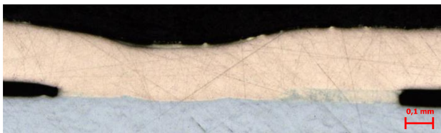
3. ábra: Ellenállás dudorhegesztett kötés (pozitív kupak, bal oldal)
