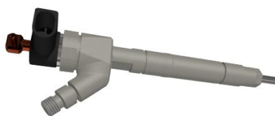
5. ábra. Bosch CR 0445110190 típusú injektor CAD modellje
