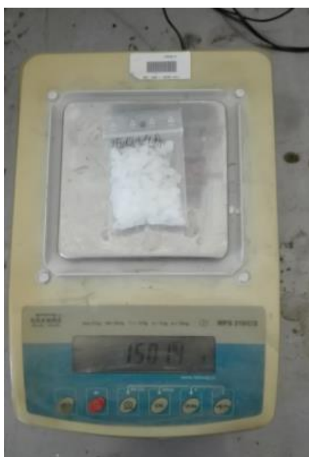
4. ábra. RADWAG WPS 210/C/2 digitális mérleg
