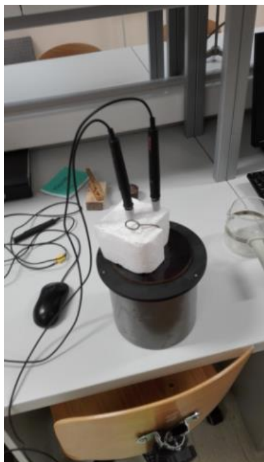
3. ábra. A kaloriméter a ráhelyezett szenzorokkal
