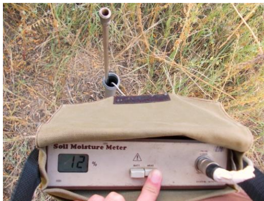
3. ábra: A nedvességmérő műszer digitális kijelzője
